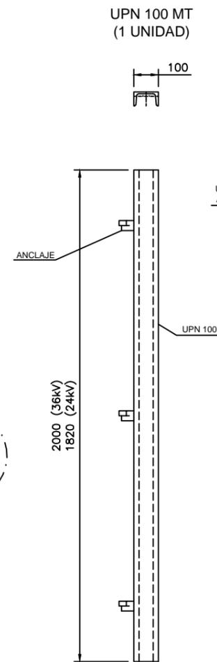
NOTA: TODOS LOS MARCOS SE CONECTARAN A LA MALLA EQUIPOTENCIAL POR SOLDADURA DE, AL MENOS DOS DE SUS ANCLAJES
