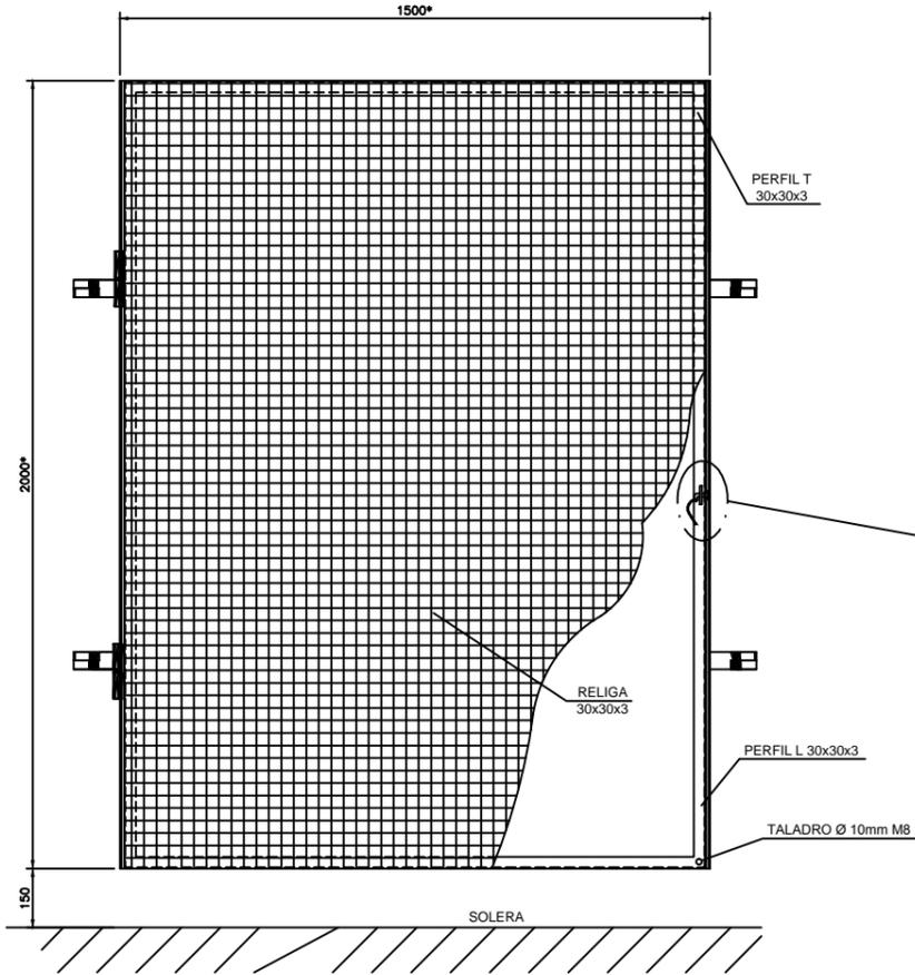
LA COLOCACIÓN DE LAS BISAGRAS HA DE HACER POSIBLE ABRIR LA PUERTA EN LA DIRECCIÓN CORRECTA, SEGÚN EL PLANO DE OBRA CIVIL.
