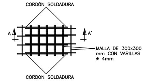
EL SOLAPE DE LAS MALLAS SE REALIZARÁ COMO MÍNIMO EN CUATRO CUADRICULAS, SIEMPRE QUE SEA POSIBLE. LA UNIÓN SE REALIZARÁ POR SOLDADURA ELÉCTRICA U OXICETILÉNICA Y COMO MÍNIMO EN DOS DE CADA CUATRO VARILLAS EN EL SENTIDO DEL SOLAPE.
