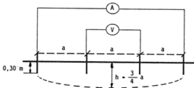
Dada la profundidad máxima a la que se instalará el electrodo de puesta a tierra del CT ( $h$ ), se calculará la interdistancia entre picas para realizar la medición mediante la siguiente expresión:
