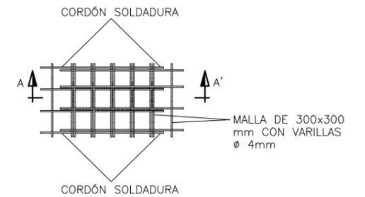
EL SOLAPE DE LAS MALLAS SE REALIZARÁ COMO MÍNIMO EN CUATRO CUADRÍCULAS, SIEMPRE QUE SEA POSIBLE. LA UNIÓN SE REALIZARÁ POR SOLDADURA ELÉCTRICA U OXIACETILÉNICA Y COMO MÍNIMO EN DOS DE CADA CUATRO VARILLAS EN EL SENTIDO DEL SOLAPE.
