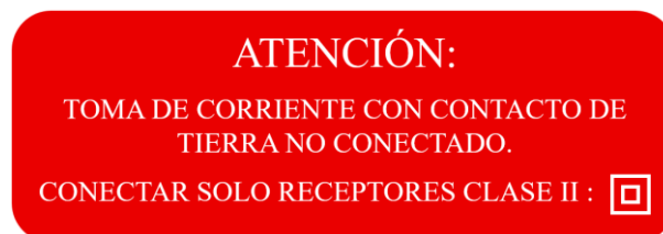
Figura 15 Rótulo de aviso a situar junto a la toma de corriente
