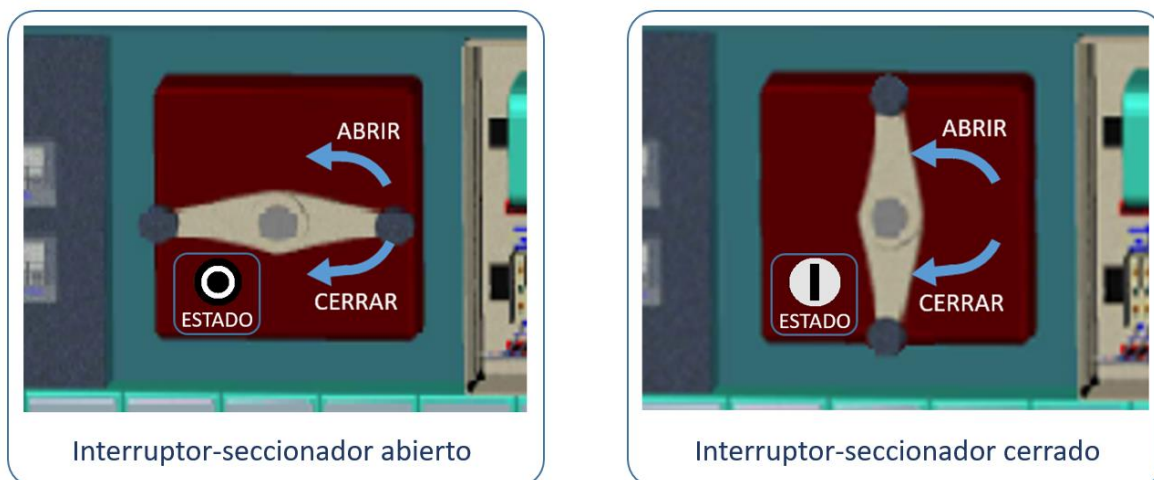
Figura 27 Ejemplo de indicación de estado y de direcciones de maniobra en interruptor-seccionador general.
